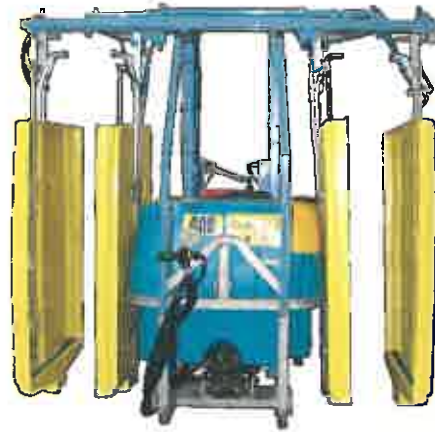
S21 Panneaux récupérateurs
