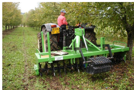
Passage du Aairsol en verger totalement enherbé ©SC-CDA 47
